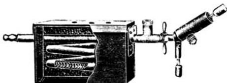
Durchschnittszahlen angenommen, keine forcierte Leistung.) Diese Zahl ist im Vergleich zu den Überhitzern der Betriebe außerordentlich hoch und ist bedingt durch eine eigenartige Führung der Dämpfe und der Feuerungsgase; nur auf diese Weise ist es möglich gewesen, diesen Schlangenüberhitzer in so kleine Form zu zwängen.
